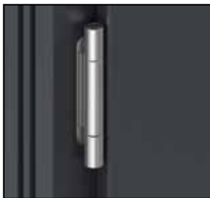
Петля Premium Simonswerk серии 4000 • релуляция 3D • грузоподъемность 160 кг. • усиленная противозломность • гарантия эксплуатации 30 лет (200 тыс.циклов)
